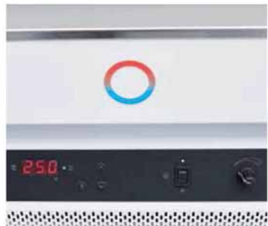
Bedienung links: Temperatureinstellung mit LED Anzeige, rechts: DrehzahlEinstellung der Schüttel-einheit
